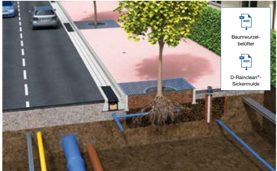
*Optimale Standortbedingungen schaffen der Baumwurzelbelüfter und D-Rainclean®-Sickermulde von Funke. Die Wasserzufuhr zum Wurzelballen erfolgt über ein Teilsickerrohr*
